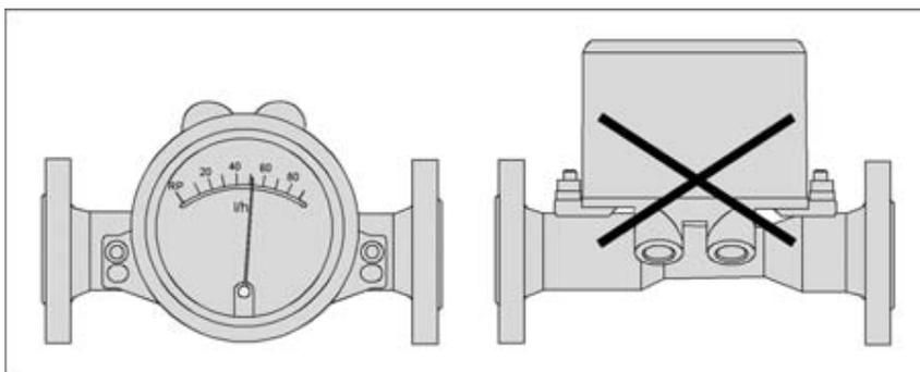
A fim de cumprir com os parâmetros térmicos e de precisão de medição, medidores de fluxo para instalação horizontal devem ser instalados na calha de modo que o mostrador esteja localizado no lado do tubo de medição. As precisões declaradas só valem se as temperaturas máximas ambiente e do produto forem respeitadas.
